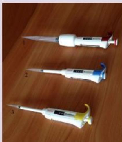
Рис. 7. Пипетки-дозаторы одноканальные переменного объёма: 1 — 1—10 мл; 2 — 100—1000 мкл; 3 — 10—100 мкл.
