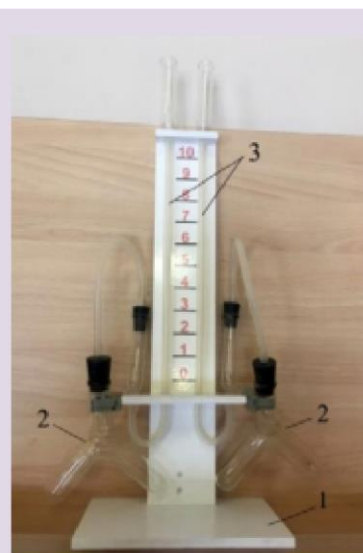
Рис. 5. Прибор для демонстрации зависимости скорости химических реакций от различных факторов: 1 — подставка; 2 — сосуды Ландольта; 3 — манометрические трубки
