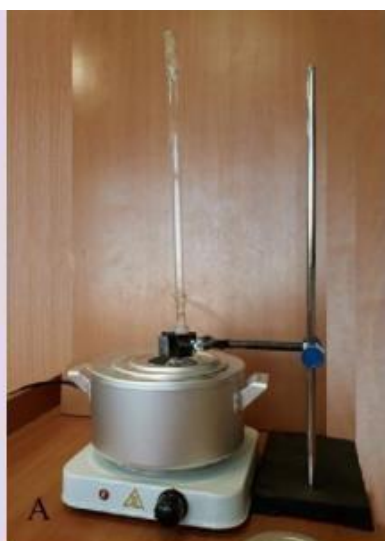
Рис. 8. Баня комбинированная лабораторная. А — водяная баня. Б — песчаная баня
