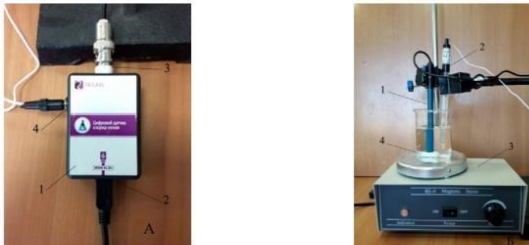
Рис. 3. Установка для определения концентрации (активности) хлорид-ионов в растворе. А: 1 — корпус датчика для определения \text{Cl}^- -ионов; 2 — разъём Micro USB для подключения к компьютеру; 3 — разъём BNC для подключения рабочего электрода; 4 — разъём для подключения электрода сравнения; Б: 1 — ионоселективный электрод (рабочий электрод); 2 — электрод сравнения (хлорсеребряный электрод); 3 — магнитная мешалка; 4 — якорь магнитной мешалки
