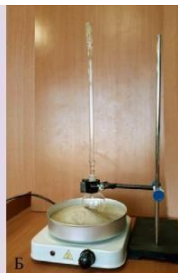
Рис. 8. Баня комбинированная лабораторная. А — водяная баня. Б — песчаная баня
